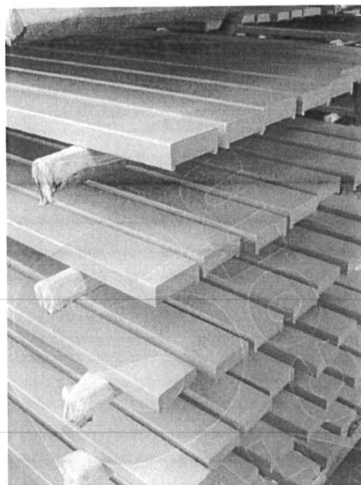
En sortie de ligne, bois traités par saturateur après imprégnation ignifugeante en autoclave.
