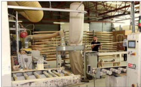
Pour traiter le bois contre le feu ou le peindre, le patron de Fibex a investi dans deux chaînes automatisées. Photo VM/Philippe BRIQUELEUR
